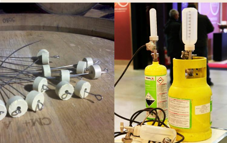
Figure 2. Deux formes d'utilisation du SO<sub>2</sub> en œnologie, de gauche à droite : mèches de soufre, SO<sub>2</sub> sous forme gazeux (O. Colas).
