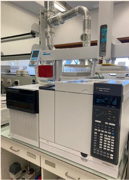
Figure 6. GC-MS pouvant être utilisé pour doser le SO<sub>2</sub>.
